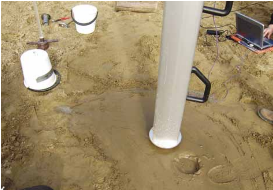
Hevosurheilupohjien joustoa voidaan tutkia jouston mittaamiseen kehitetyllä painonpudotuslaitteella. Mitä korkeampi arvo saadaan, sen kovempi ja nopeampi pohja on. Raviratojen jouston moduuliarvo on 120 – 160 välillä ja hyvien ratsastus kenttien arvo on 40 – 70 välillä. Kova pohja kuitenkin rasittaa hevosten jalkoja ja jatkuva kovalla pohjalla kulkeminen tarkoittaa suurempaa riskiä jalkavammojen syntymiseen. Myös liian joustava ja pehmeä pohja aiheuttaa helposti jalkaongelmia.
